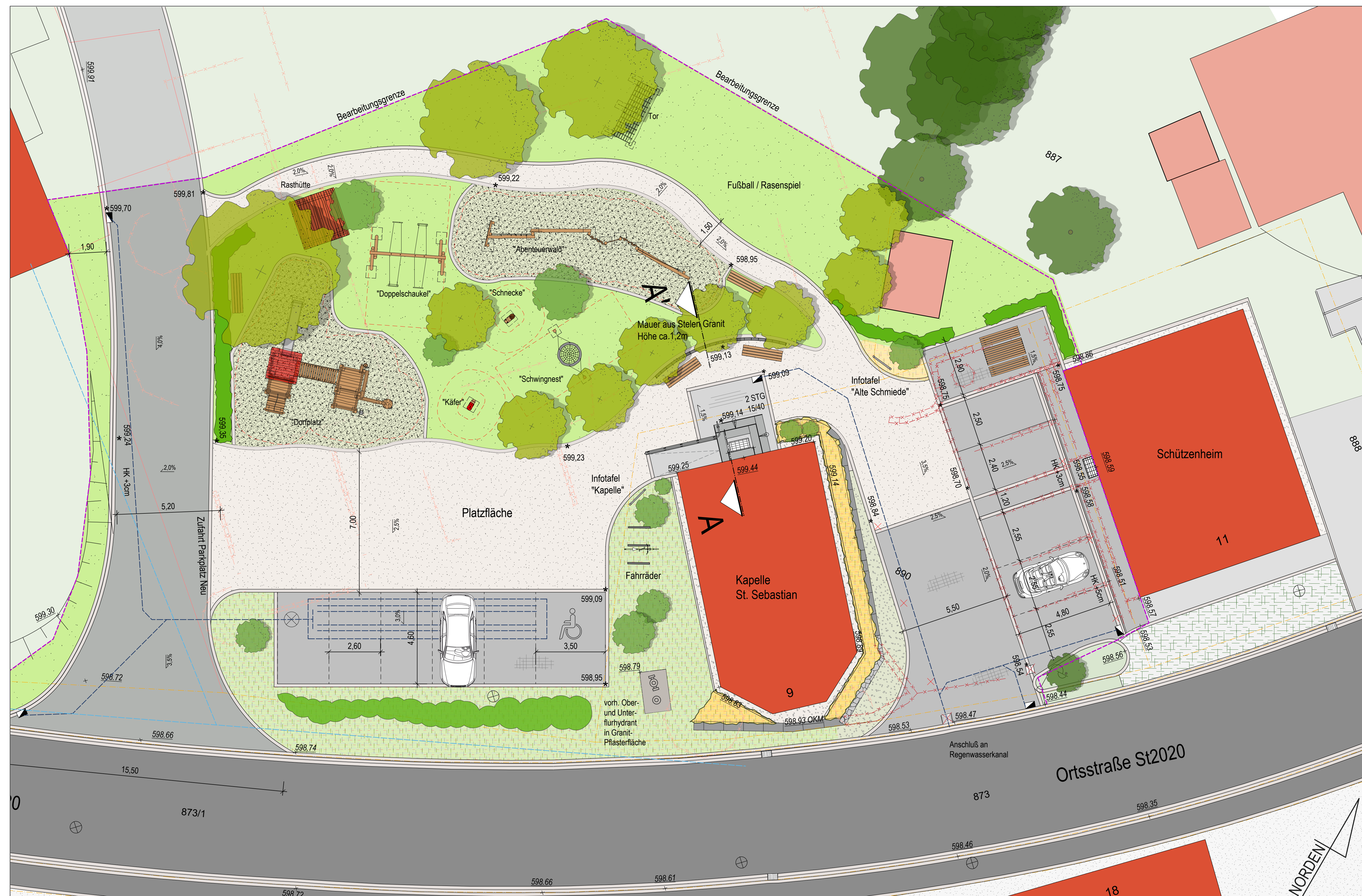
Gestaltungsbeispiel: Wassergebundene Decke mit Bindemittel "Stabilizer" mit Einfassung Granit-Großpflaster, gebrochen, 1-zellig
